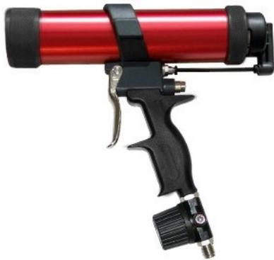
Durch die besondere Schnellentlüftung ist ein Dosieren möglich, ohne dass Material am Ende des Arbeitsganges nachläuft. Somit kann auch z. B. ein hochviskoses Silikon sauber, wie aus einem Ventil, dosiert werden.
